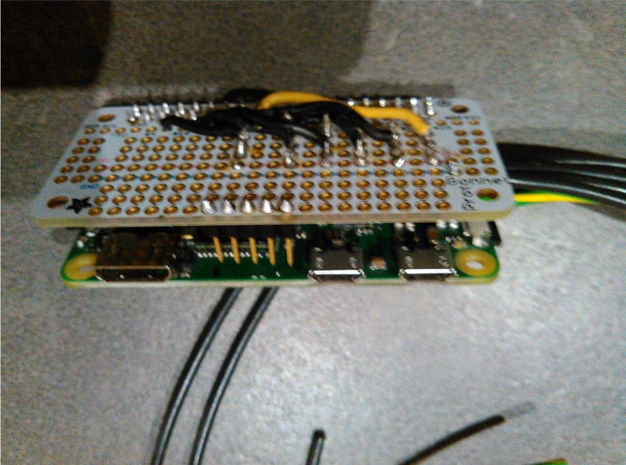
Le montage intégré dans le boîtier: on voit l'horloge RTC qui « dépasse » du sandwich, les fils rouge et bleu vont à l'écran pour le réglage de luminosité. L'alimentation « arrive » à gauche, les boutons et capteur « arrivent » par la droite. J'ai aussi rajouté un interrupteur général avant le convertisseur. Le fusible est sur le faisceau, sous la selle.
